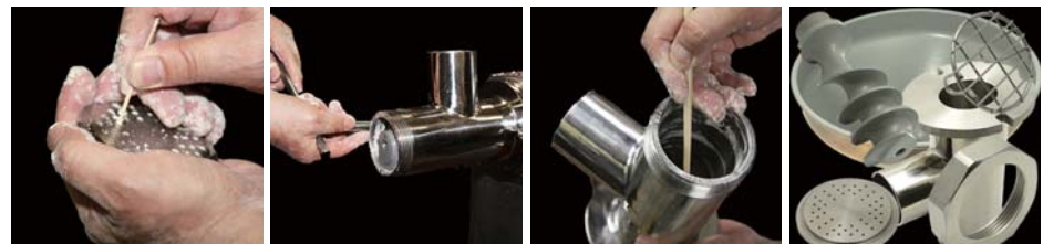
フレンジに残っている生地を表面から落とします 付属の専用工具でパイプ本体を取り外します 溝などに残った生地を落とします 細かい生地落とし後は各パーツを水洗いして完了
