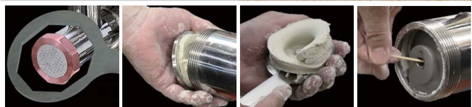
付属の専用工具でフレンジ止めを外します フレンジを抜き取ります フレンジに残った生地をすくい取ります スクリュー押し出し口付近の生地を取ります
